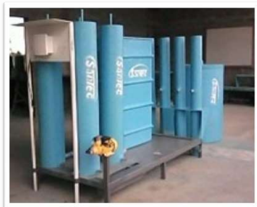
Kit 5: Unidade de mini estação de tratamento de água
