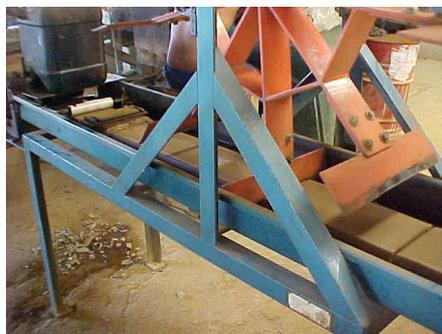
Figura 2 – Cortador mecânico giratório (idem)
