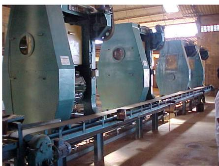
Figura 3 – Prensas modernas para produção de telhas (Cerâmica C)
