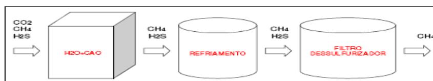
Figura 1 – Fluxograma do caminho percorrido pelo biogás para sua purificação:
