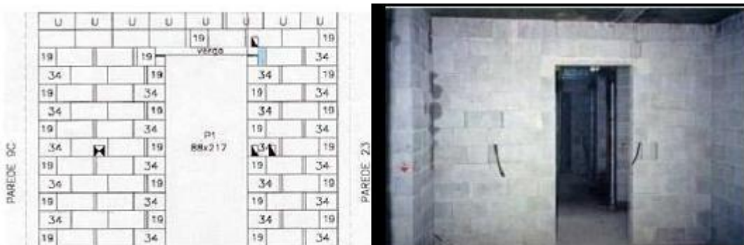
Figura 1 – Alvenaria de blocos concebida por Engenharia Simultânea
