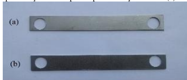
Figura 5: Representação dos corpos de prova do aço AISI304 (a) e AISI2205 (b).
