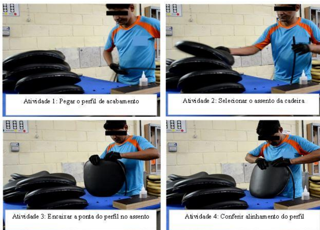
Figura 4 – Início das atividades do colaborador para colocação do perfil de acabamento das cadeiras
