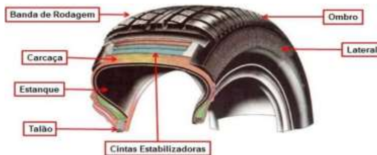
Figura 1 - Estrutura e partes do pneu
