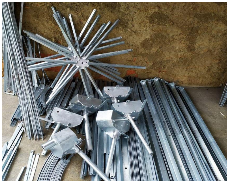
Figura 3 – Partes do catavento após processo de galvanização.
