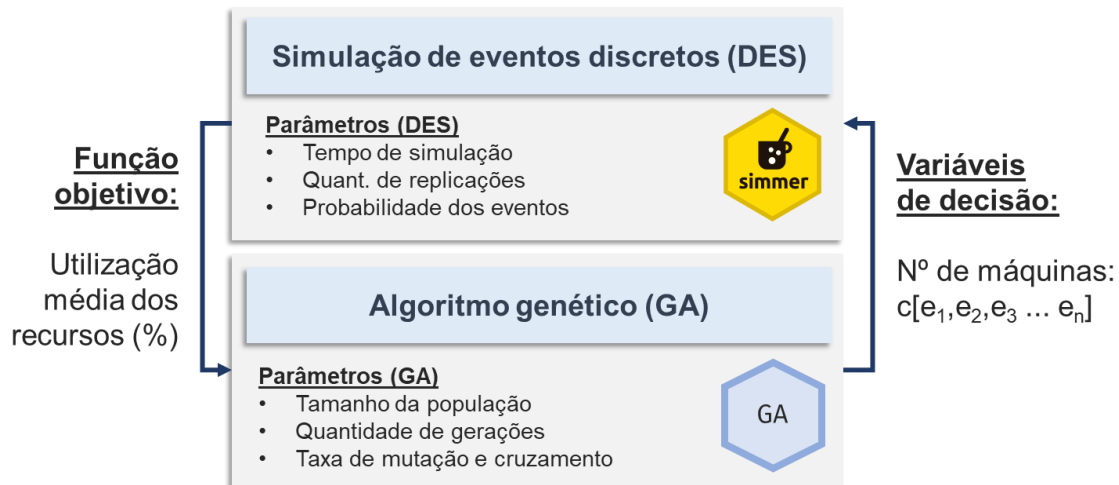
Figura 3 - Otimização baseada em simulação para balanceamento de linha de produção
