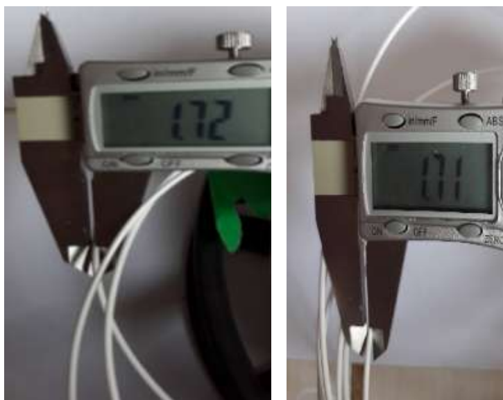
Figura 11 - Medição do diâmetro do filamento PLA reciclado
