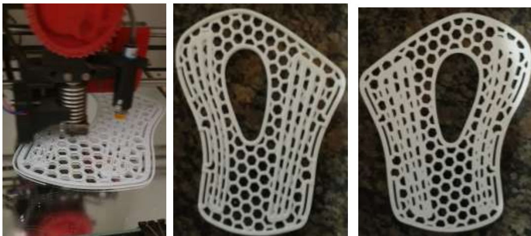
Figura 14 – Fabricação do órtese de punho modelo 2
