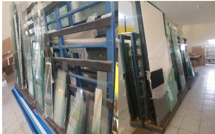
Figura 4- Cavalete com refugos e pedidos de vidros já cortados
