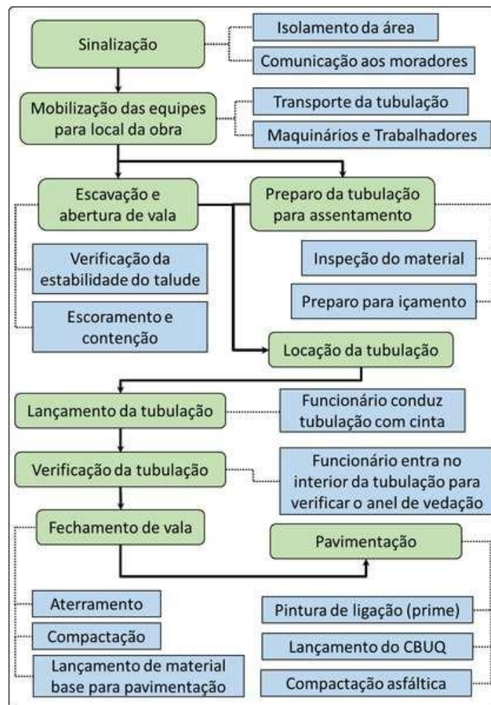
Figura 5–Fluxograma das tarefas do processo de assentamento de tubulação FD DN 800
