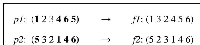
Figura 4 – Exemplo de aplicação do *crossover* *CX*
