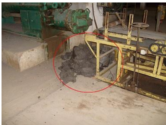
Foto 1 - Detalhe matéria-prima extrudada com problemas
