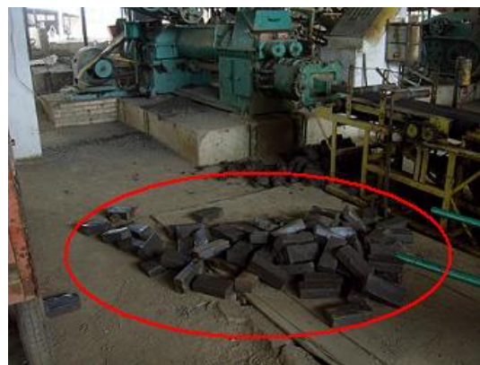
Foto 2 - Detalhe tijolos maciços cortados com problemas
