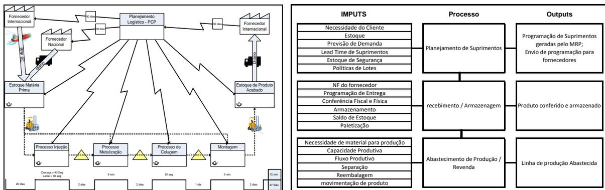
Figura 1 – Value Stream Mapping e Mapa do processo com Inputs e Outputs dos processos analisados
