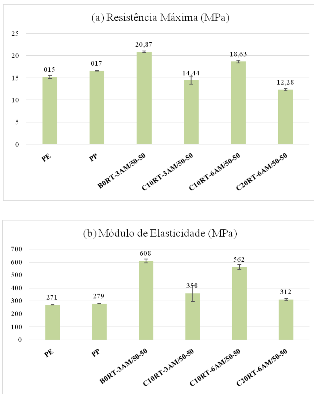
Figura 1 - Resultados de (a) resistência máxima à flexão e (b) módulo de elasticidade dos compósitos moldados.
