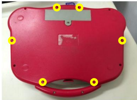
Figura 2 - Localização dos parafusos eliminados
