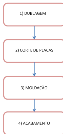
Figura 2 - Fluxograma para sequência do processo de fabricação
