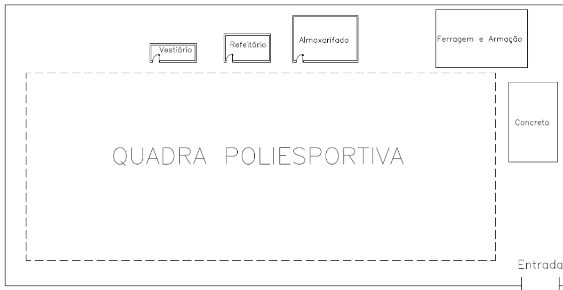
Figura 9 - Layout do canteiro de obras
