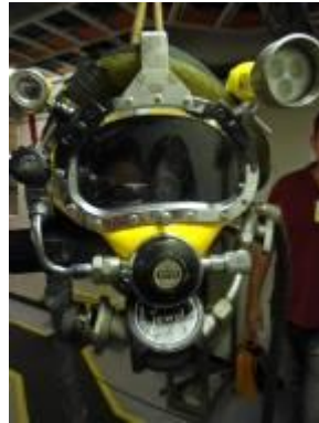
Figura 9 – Capacete com a fonia, suas válvulas, a lanterna etc.
